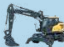
EXCAVATOARE PE PNEURI
